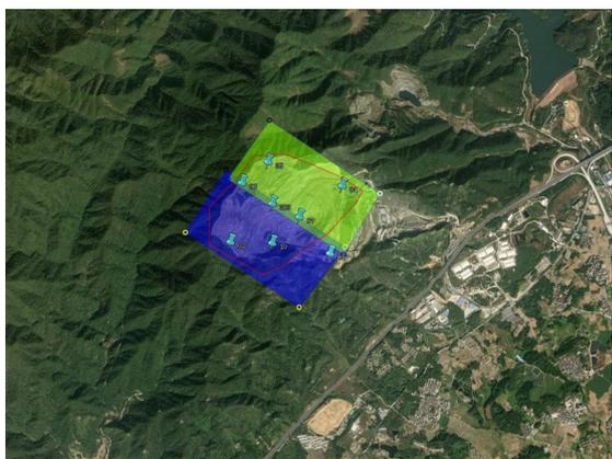
图1 区块设计和像控点布设图
