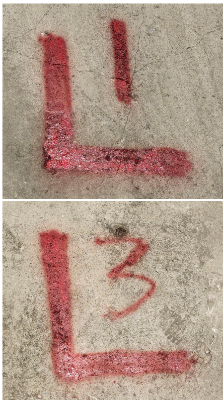
图 1 像控点实地布设图
