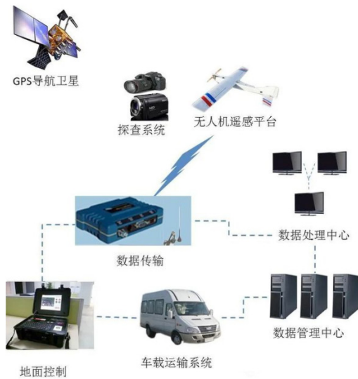
图 1 无人机遥感技术在测绘工程中的应用
