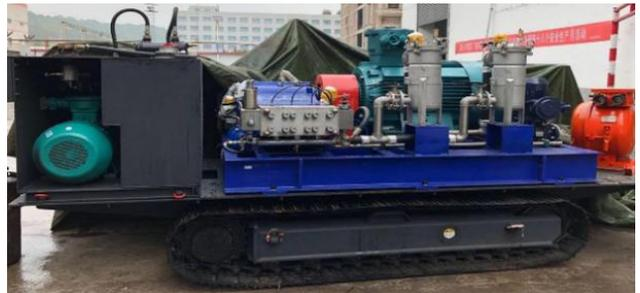
图3 高压泵组总成
