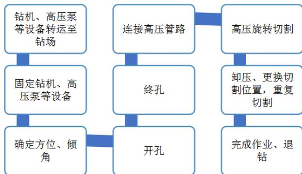
图 5 施工工艺流程图
