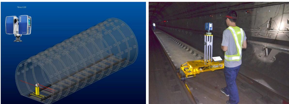
图 1 移动激光扫描测量现场数据采集操作图
