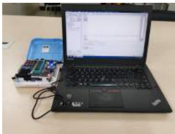
图1 《单片机原理及应用》口袋实验室 - 便携式单片机开发套件
