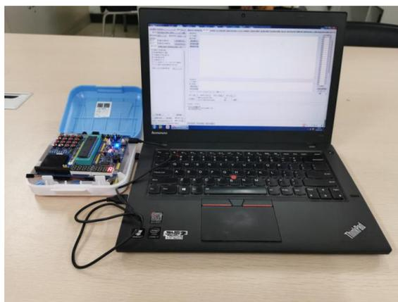
图1 《单片机原理及应用》口袋实验室 - 便携式单片机开发套件
