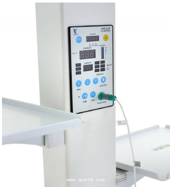
图 2 新生儿辐射保暖台控制部件
