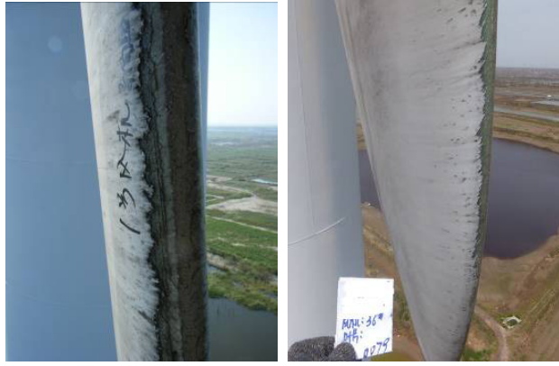
图 1 叶片前缘磨损
