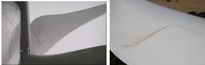
图 2 叶片产生纵向、横向裂纹
