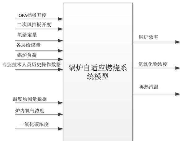
图 1 基于声学原理的炉膛温度场和速度场的燃烧优化闭环控制系统原理图
