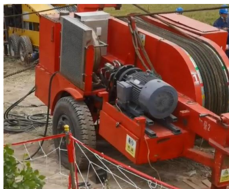
图 3 改造后的用于张力架线的张力机
