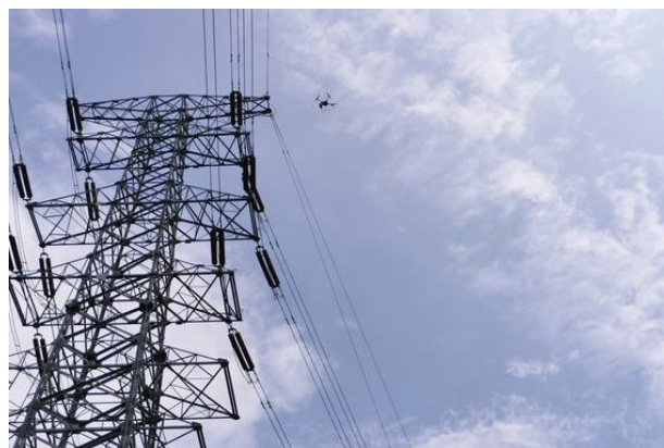
图2 无人机在架空线路运维管理中的应用
