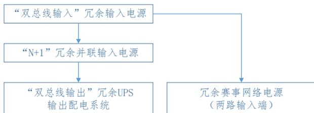
图 1 项目 UPS 冗余供电系统架构
