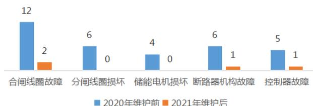
图9 并网断路器维护前后故障对比图
