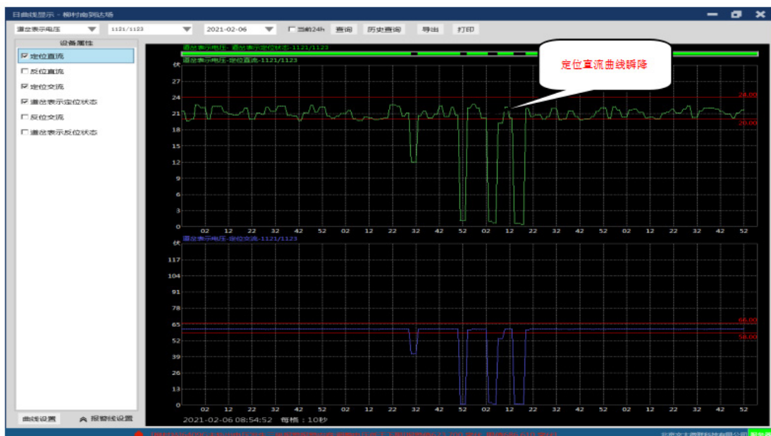
图 1 柳村南二场到达场 1121/1123 道岔定位交直流曲线
