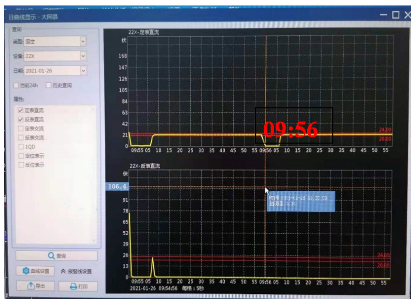
图 2 大同县站 22# 道岔故障时的定反位直流曲线
