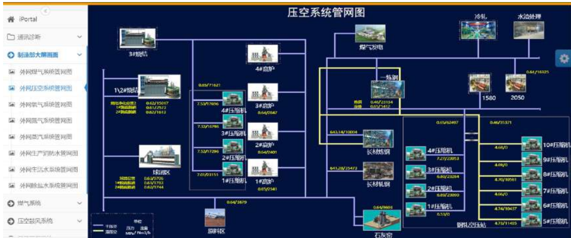
图 2 压空系统管网图
