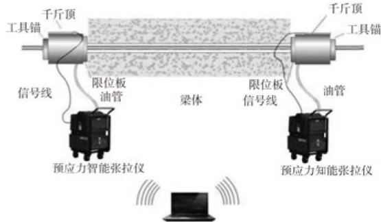
图1 预应力智能张拉系统结构
