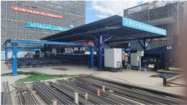
图 1 钢筋智能化加工生产线
