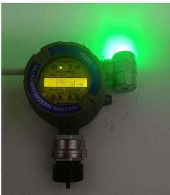
图 1 固定式硫化氢报警器
