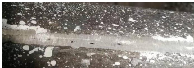
图 1 棒材表面探伤缺陷形貌
