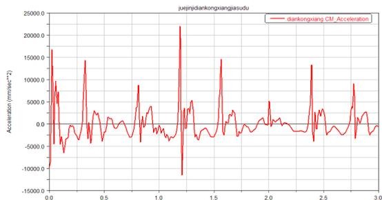
图 12 金属橡胶隔振器电控箱质心加速度
