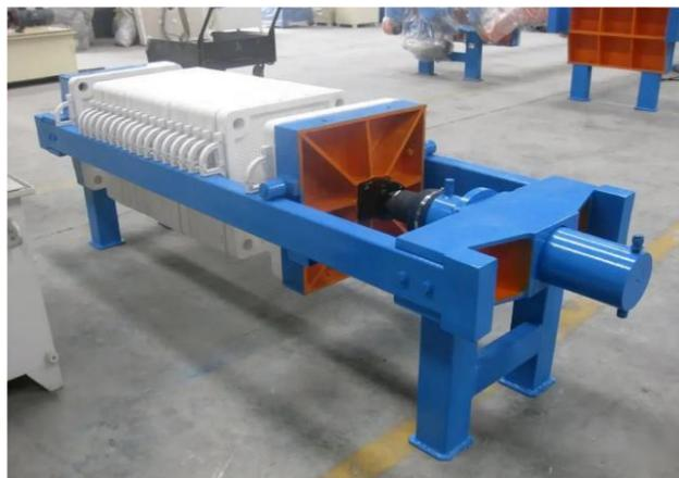
图1 板框压滤洗涤
