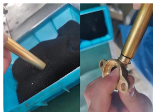
图 3 进水管沾 P-80 橡胶润滑剂
