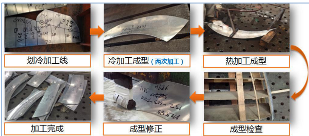
图 5 模具组织生产工艺流程
