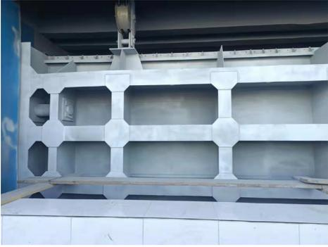
图2 防腐后闸门
