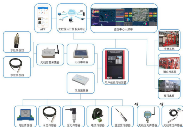
图 1 智慧水消防系统原理图
