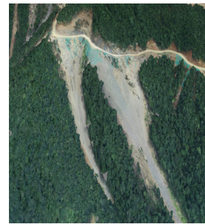
图 1 由于石方区爆破导致的长溜坡
