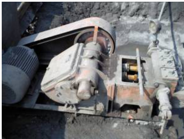
图 2 灌注桩后注浆压浆泵
