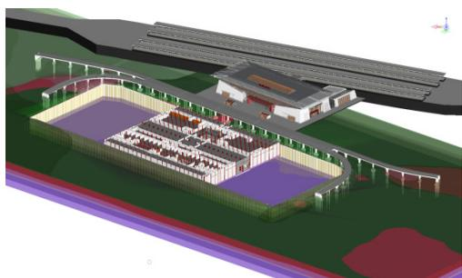
图1 站前广场及基坑支护模型图
