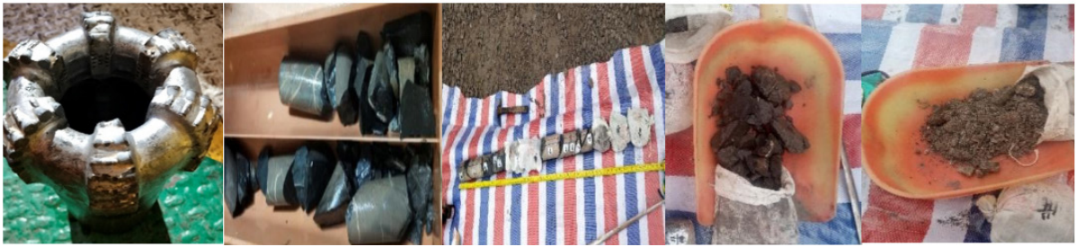
图 1 复合片 8mm+ 巴拉斯横杠齿取心钻头及出芯情况
