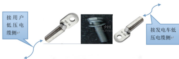
图 3 0.4kV 低压电缆对接方式（中间螺栓连接）
