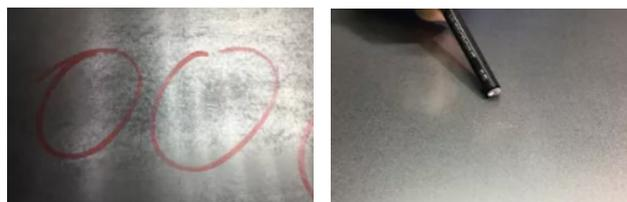
图1 热镀锌板典型锌灰形貌 图2热镀锌板表面彗星状锌灰形貌
