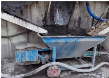
图4 岩屑密闭传输装置示意图
