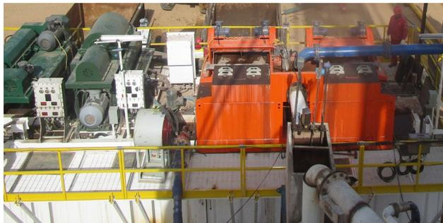
图3 固控设备集成示意图
