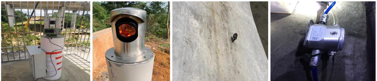
图 2 观测站、基准点、监测点及静力水准仪现场埋设图
