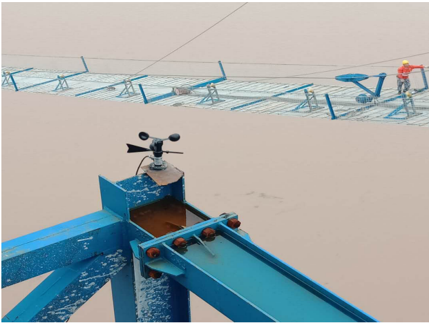
图 3 风向及风速传感器安装示意图
