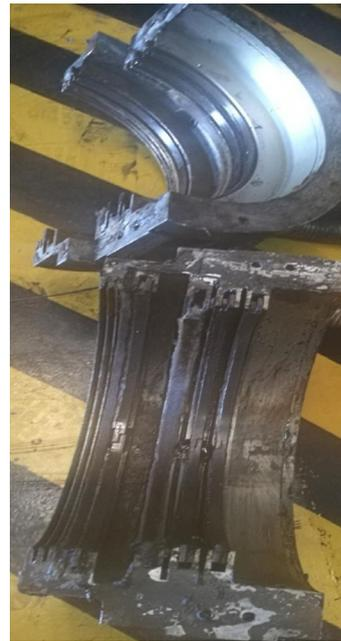
图 2 转轴和轴封油挡磨损情况（二）
