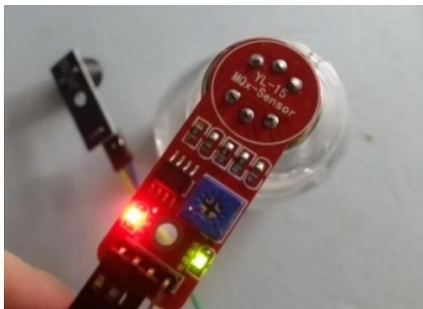
图4有害气体检测测试图
