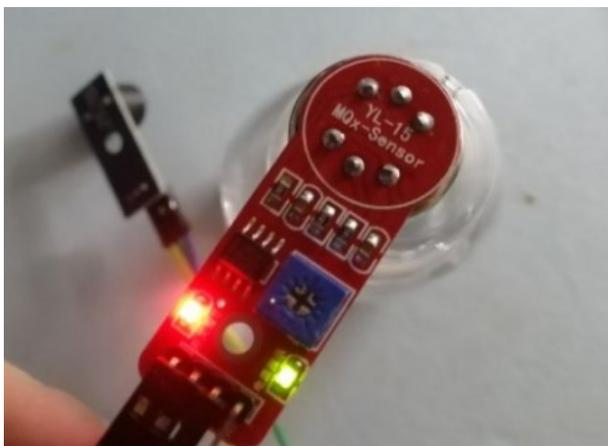
图4有害气体检测测试图
