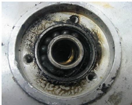
图5 破损的轴承
