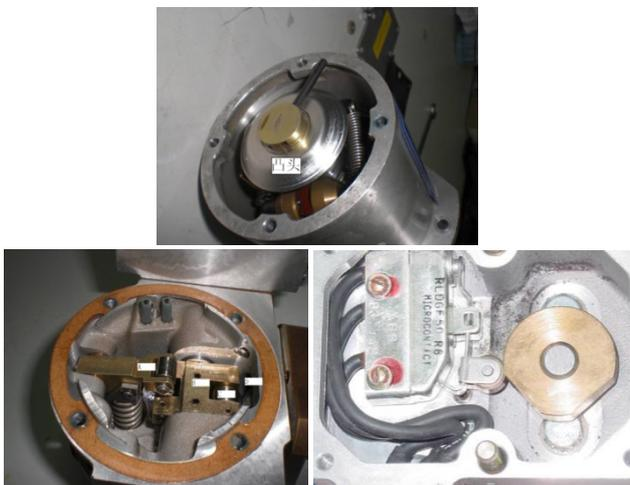
图3 内部凸轮结构
