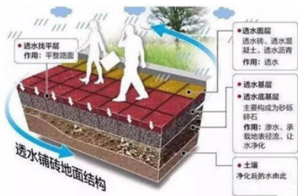
图3 透水铺装地面构造
