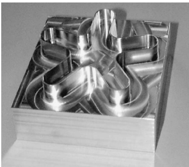
图3 超高速切削的模具零件
