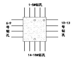
图 1 密闭墙前钻孔布置正视图
