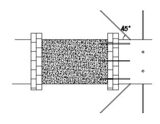
图 2 密闭墙前钻孔布置俯视图
