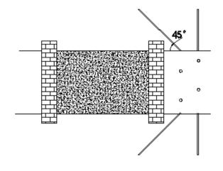
图 3 密闭墙前钻孔布置侧视图
