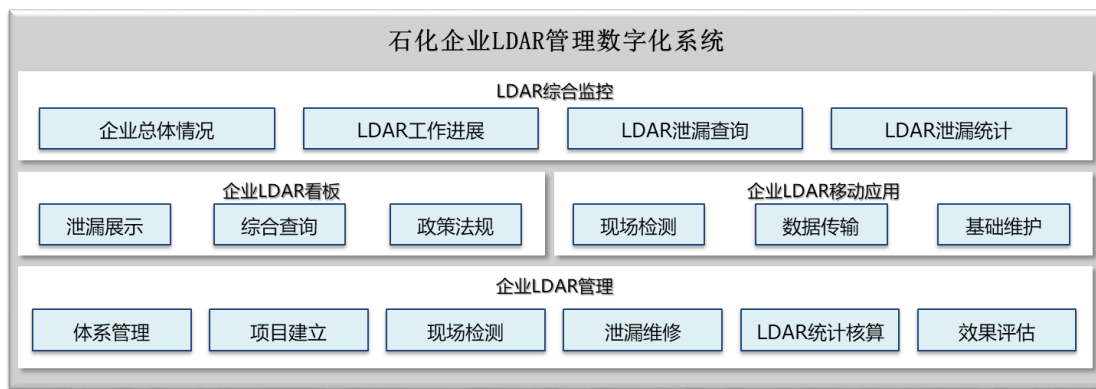
图 2 石化企业 LDAR 管理数字化系统功能框架
