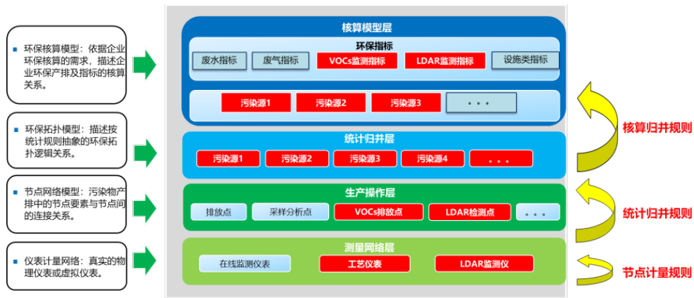
图 1 石化企业数字化环保管理系统的工厂模型
