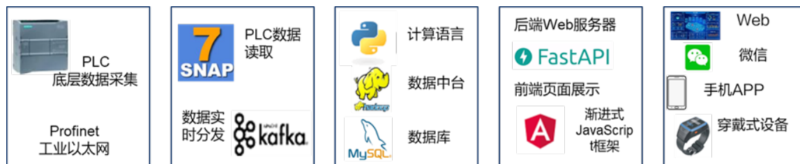
图 1 智能维修模型架构
